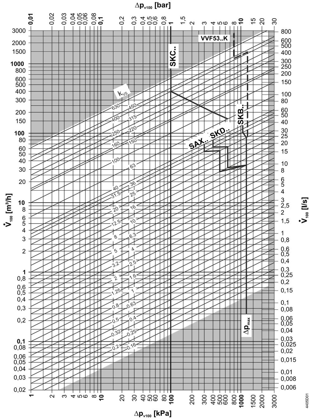
$\Delta p_{max}$  值是针对合流阀，而针对分流阀的  $\Delta p_{max}$  值参见第 2 页型号概览
